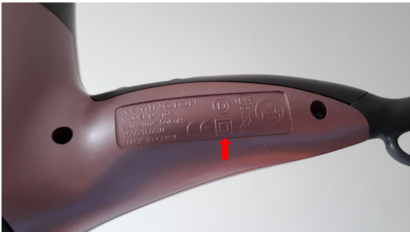
14. ábra: Kettős szigeteléssel rendelkező hajszárító adattáblája. A kettős szigetelést az adattáblán két koncentrikus négyzet jelöli.
